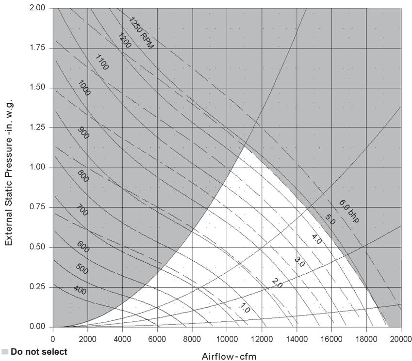
Figure 70: RAH 077C (3) 36" propeller exhaust fan
